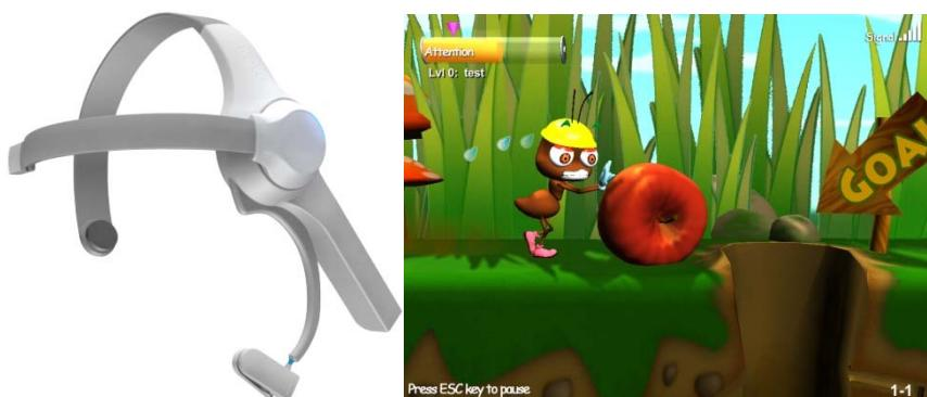
Figure 2 : Application BCI avec le jeu « The Mindty Ant » utilisé avec le casque EEG Mindwave de Neurosky. Le personnage avance si le niveau de concentration, obtenu par le capteur EEG à partir de l'onde Beta, est suffisant.
