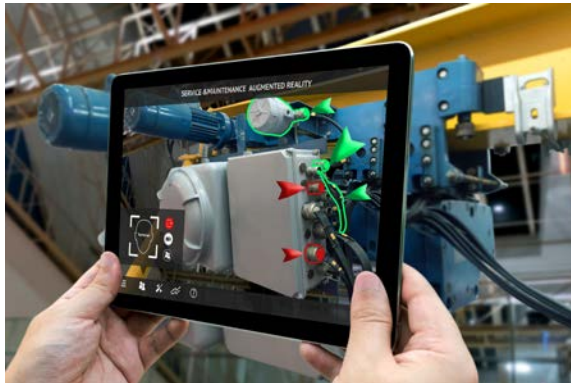
Figure 17- Système de réalité augmentée dans une application de maintenance industrielle
