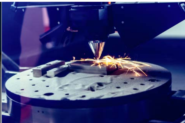
Figure 12- Fusion de poudre projetée (BEAM)
