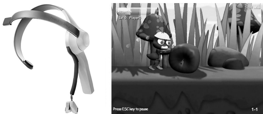
Figure 2 : Application BCI avec le jeu « The Mindy Ant » et le casque EEG Mindwave développés par la société Neurosky. Le personnage avance si le niveau de concentration, obtenu par le capteur EEG à partir de l'onde Beta, est suffisant.
