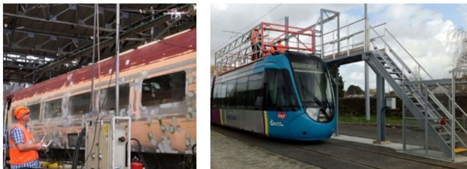
Figure 43. Inspection d'une toiture de train avec un drone (gauche) et avec une passerelle (droite).
