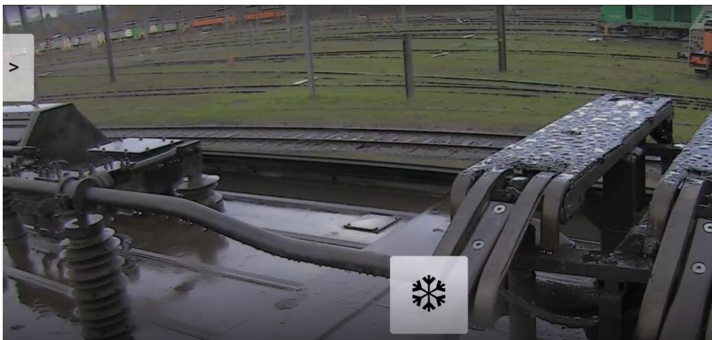
Figure 76. Retour image de PICAUTO sur tablette par temps pluvieux. Le bouton « flèche » donne accès au menu (zoom, orientation de la caméra) et le bouton « freeze » permet de figer l'image pour en obtenir une copie.
