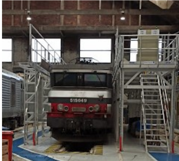
Figure 62. Passerelle pour accéder à la toiture de la locomotive.
