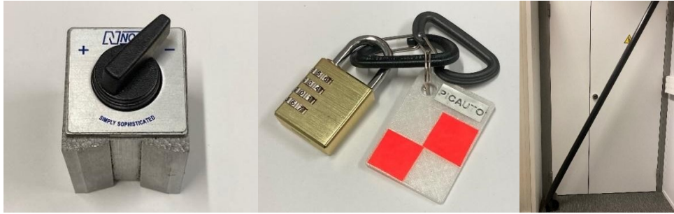
Figure 73. Les trois maquettes présentées aux agents : un pied de métrologie (gauche), un cadenas avec une plaque d'identification "PICOT" (milieu) et une perche aimantée (droit).
