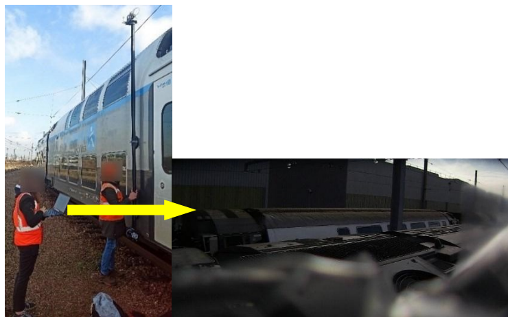
Figure 64. Situation lors du test (en haut) et retour de la caméra sur un écran d'ordinateur (photo trouble en raison d'un film de protection autour de la caméra lors du test).
