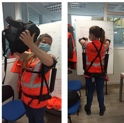
Figure 47. Essai d'un exosquelette pour le maintien des bras en l'air au technicentre.
