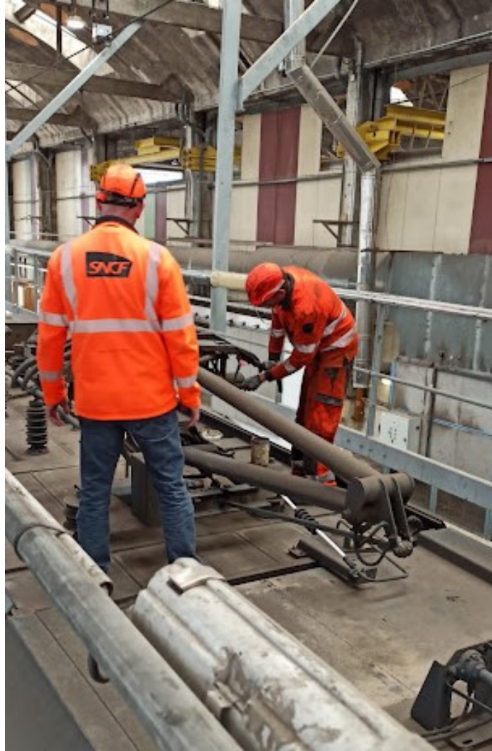
Figure 68. Deux agents en toiture de train inspectent un archet via la passerelle pour accéder à la toiture de la locomotive.
