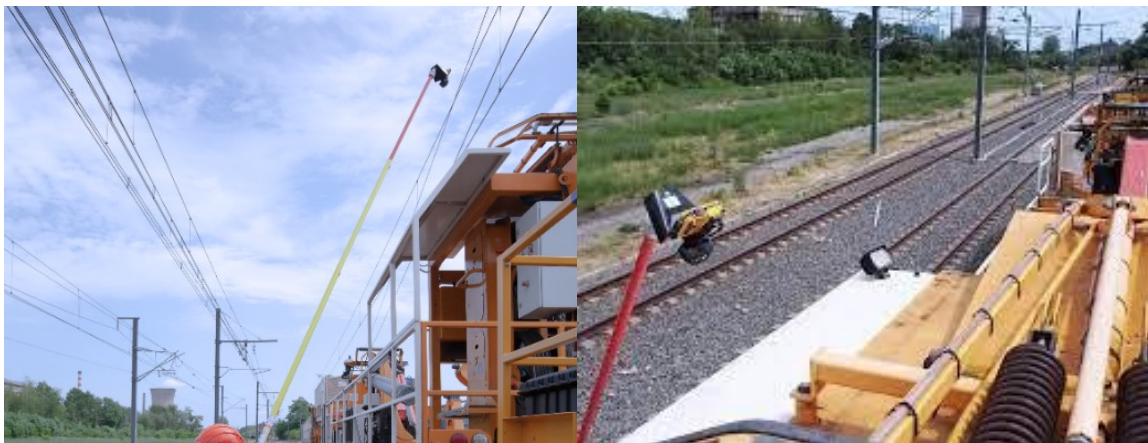
Figure 61. Kitcam, un appareil d'inspection des archets.
