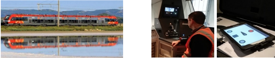
Figure 45. Une rame AGC en Occitanie (gauche) et le Robot Port'AGC fixé sur le pupitre et sa tablette de contrôle (droite).
