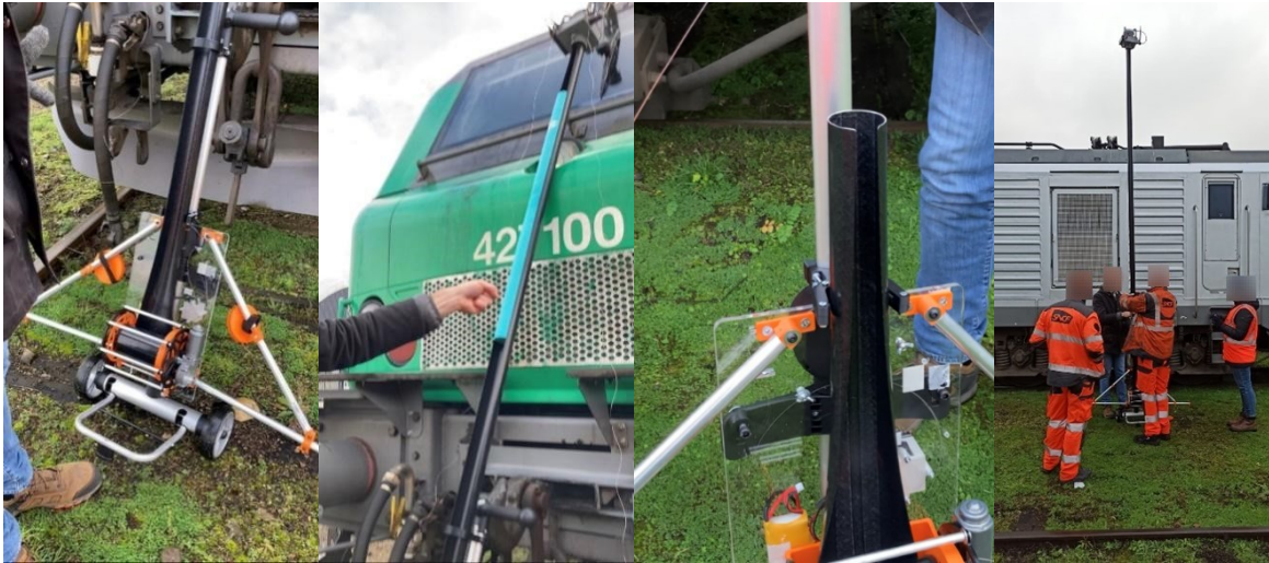
Figure 75. PICAUTO après le second prototypage. De gauche à droite : le système de haubans, le tube de mousse, pièce pour le guidage de la perche, PICAUTO déployé.
